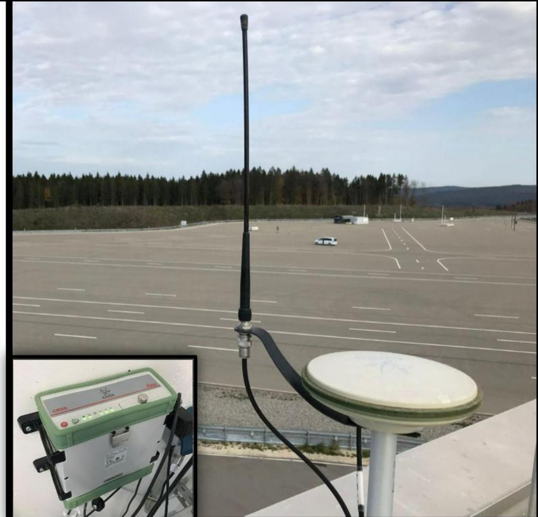
Systemaufbau für RTK-gestütztes automatisiertes Vormarkierungskonzept
